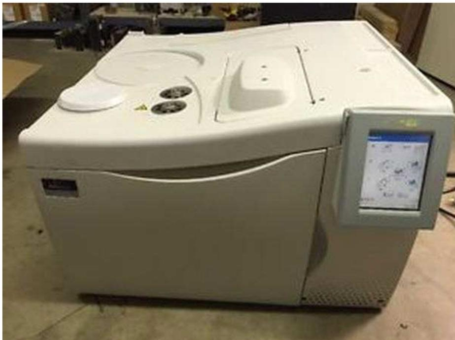
[그림 3-1] Gas Chromatography 분석 장치.
